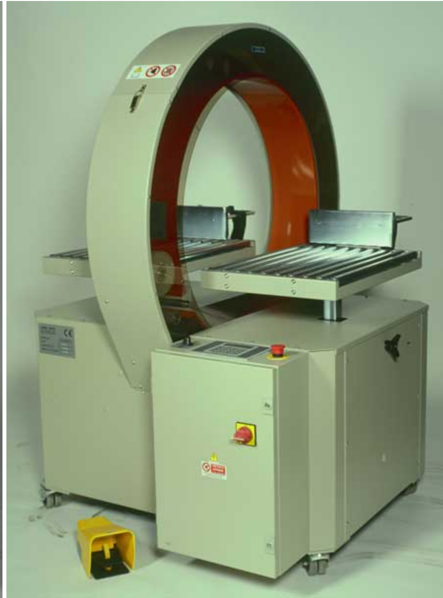
Mobil spiromaskin på hjul. 20-100 V/min. 800 mm
