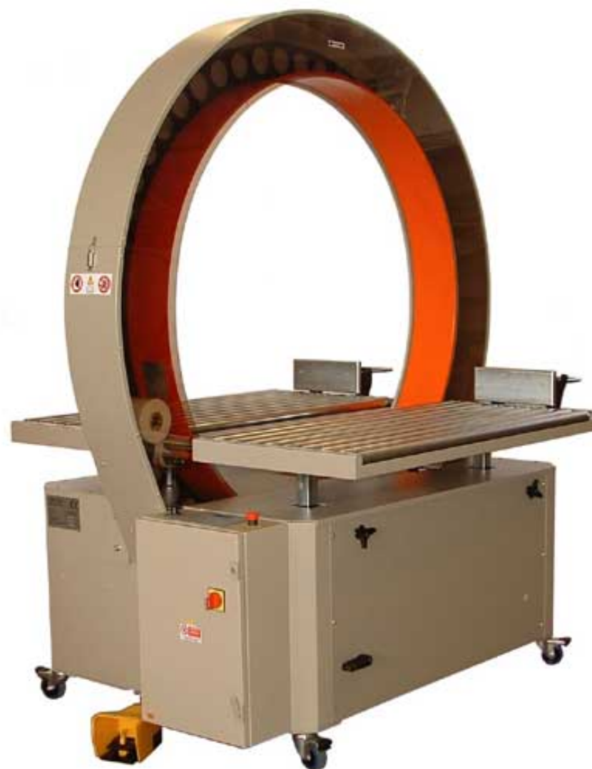
Mobil spiromaskin på hjul. 20-60 V/min. 1500 mm
